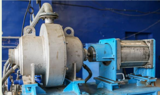
Испытания 2-х поточной турбины и ЭГ
