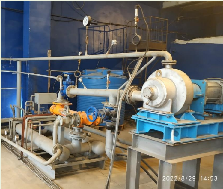
2-х поточная микротурбина 30 кВт, 12000 об/мин
