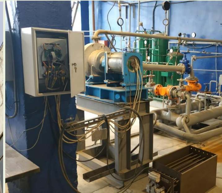
ВИЭГ 30 кВт, 12000 об/мин, Блок нагрузки
