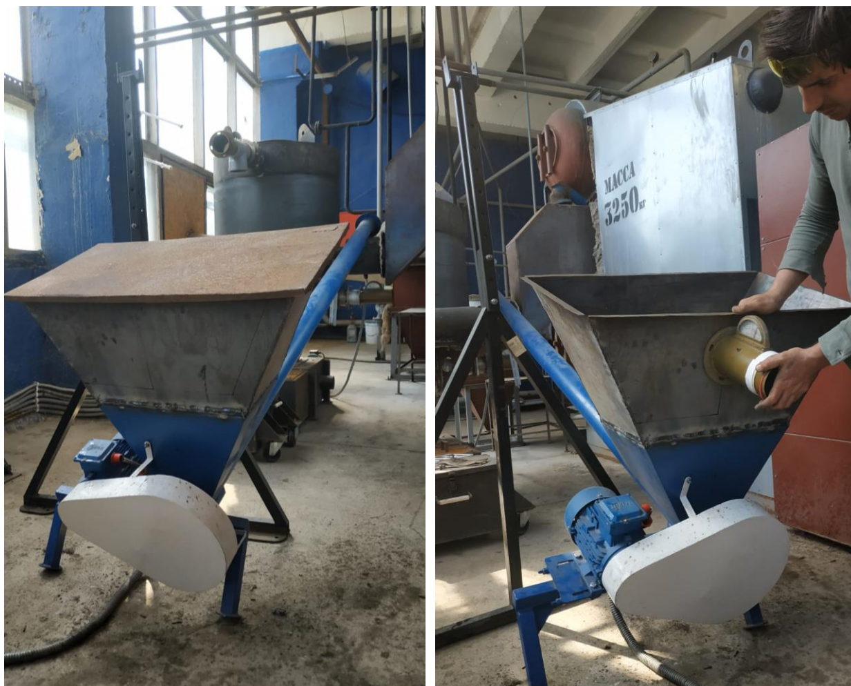
Рисунок 12 – Изменение конструкции бункера сырья
