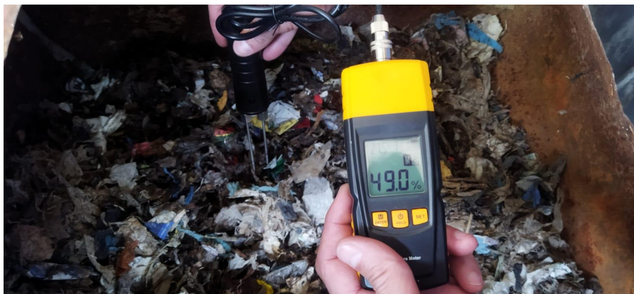
Рисунок 6 – Высоковлажное сырье после естественной сушки, влажность около 50%
