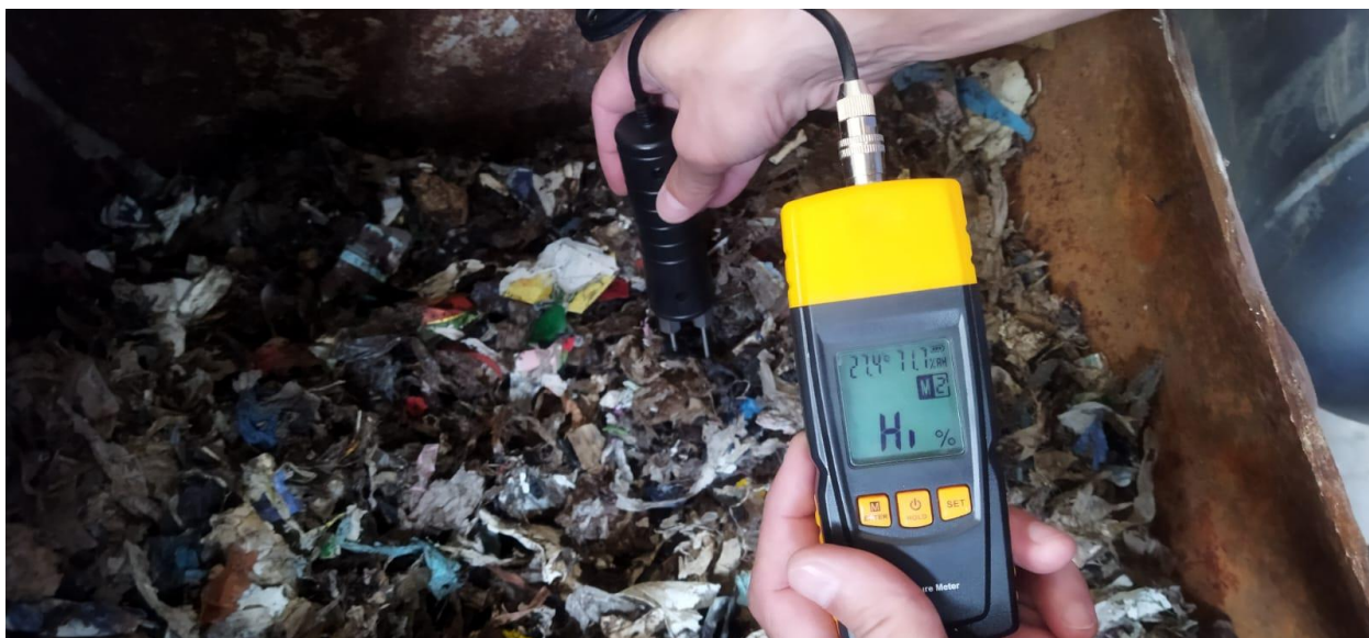
Рисунок 4 – Высоковлажное сырье, влажность более 70%
