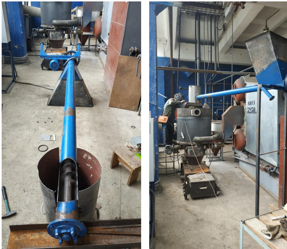
Рисунок 11– Изменение конструкции шнека подачи топлива
