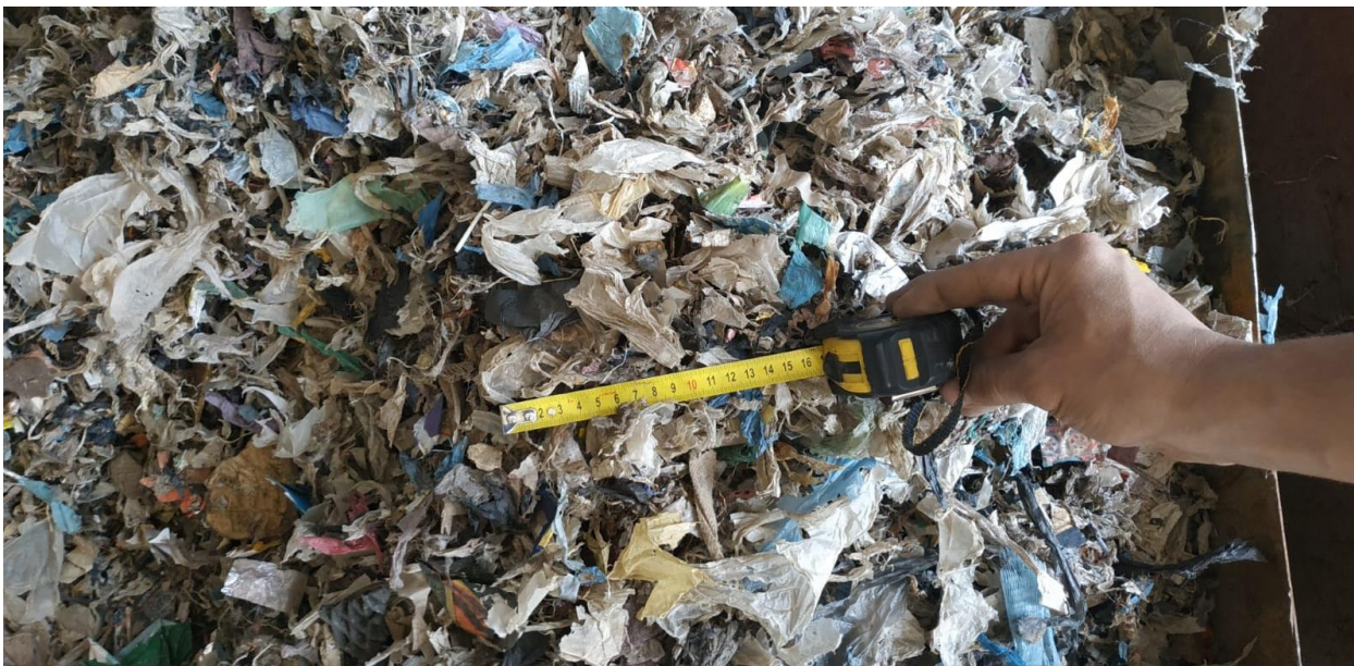
Рисунок 1 – Топливо для испытаний. Размер отдельных составных частей – более 100 мм
