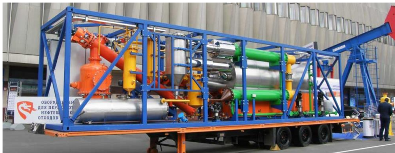
Мобильный комплекс по переработке ТКО УТД-2-200 в блочно-модульном исполнении
