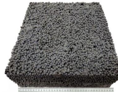
Легкий бетон на основе гранулированного пеношлакостекла
