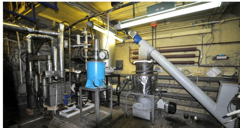
Экспериментальная установка переработки отходов на основе технологии пиролиза
