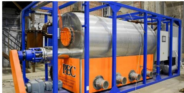
Мобильный комплекс по переработке ТКО УТД-2-200 в блочно-модульном исполнении
