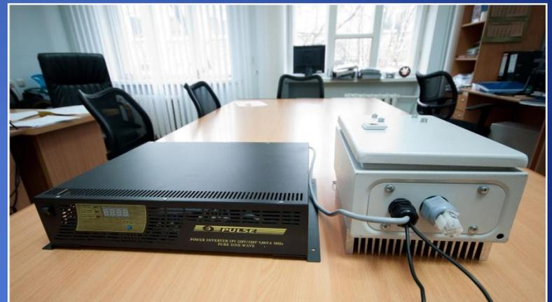
Внешний вид устройства преобразования, согласования и распределения эл. энергии
