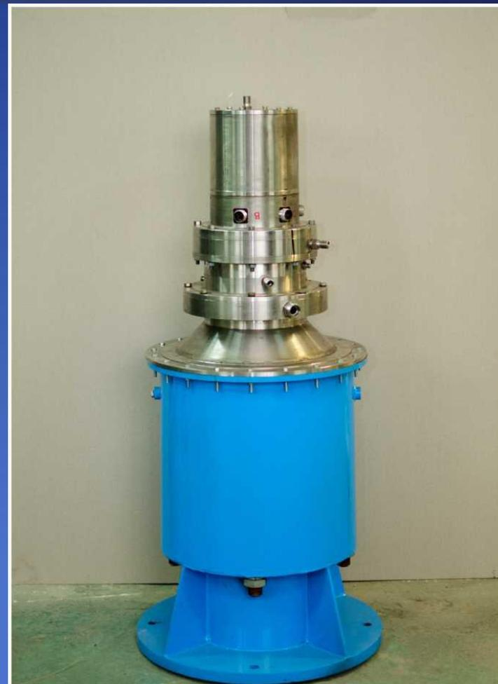
Внешний вид влажно-паровой микротурбины мощностью 5 кВт
