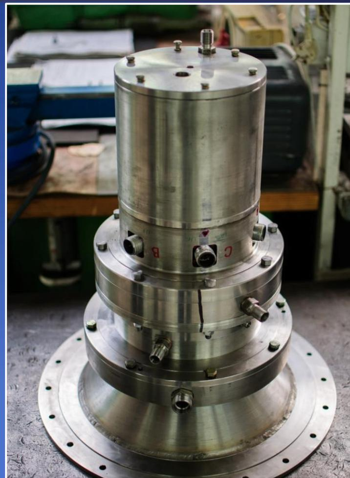
Внешний вид турбогенератора влажно-паровой микротурбины
