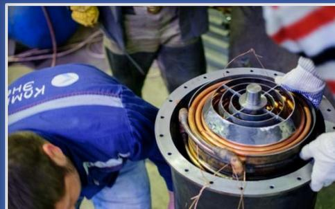
Внешний вид конденсатора влажно-паровой микротурбины
